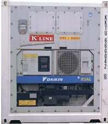
Resim-12/A Bütünleşik Reefer Üniteleri (Mekanik Soğutmalı-Isıtmalı)
