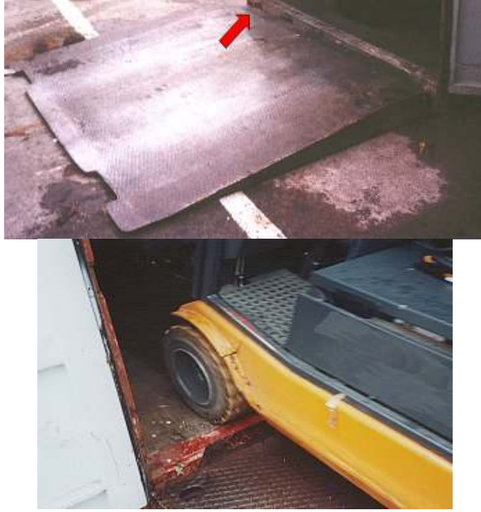
Uygun olamayan (düşük) rampa şekilleri
