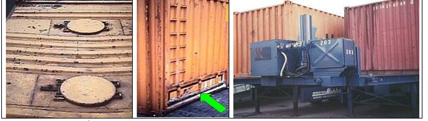
Resim-10/A Dökme Yük konteyneri doldurma ve boşaltma kapakları ve ekipmanı
