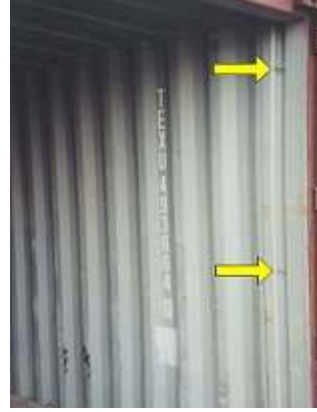
Konteynerin iç kısmındaki lařing noktası rnekleri (stte ve altta)
