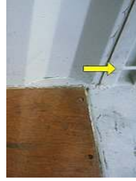
Konteynerin iç kısmındaki lařing noktası rnekleri (stte ve altta)
