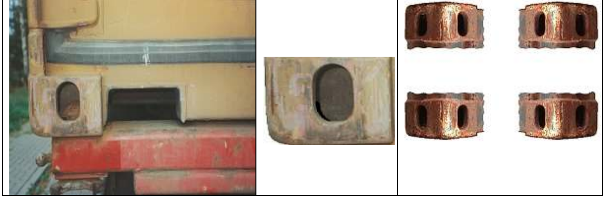
Resim-3: Konteyner kilit (Twist lock) yuvaları
