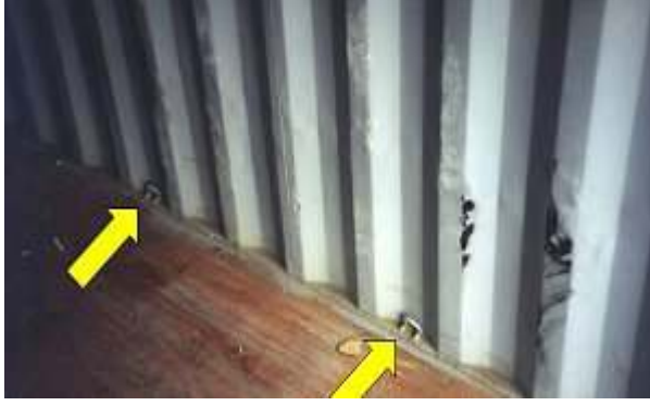
Konteynerin iç kısmındaki lařing noktası rnekleri (stte ve altta)
