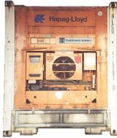
Resim-12/A Bütünleşik Reefer Üniteleri (Mekanik Soğutmalı-Isıtmalı)
