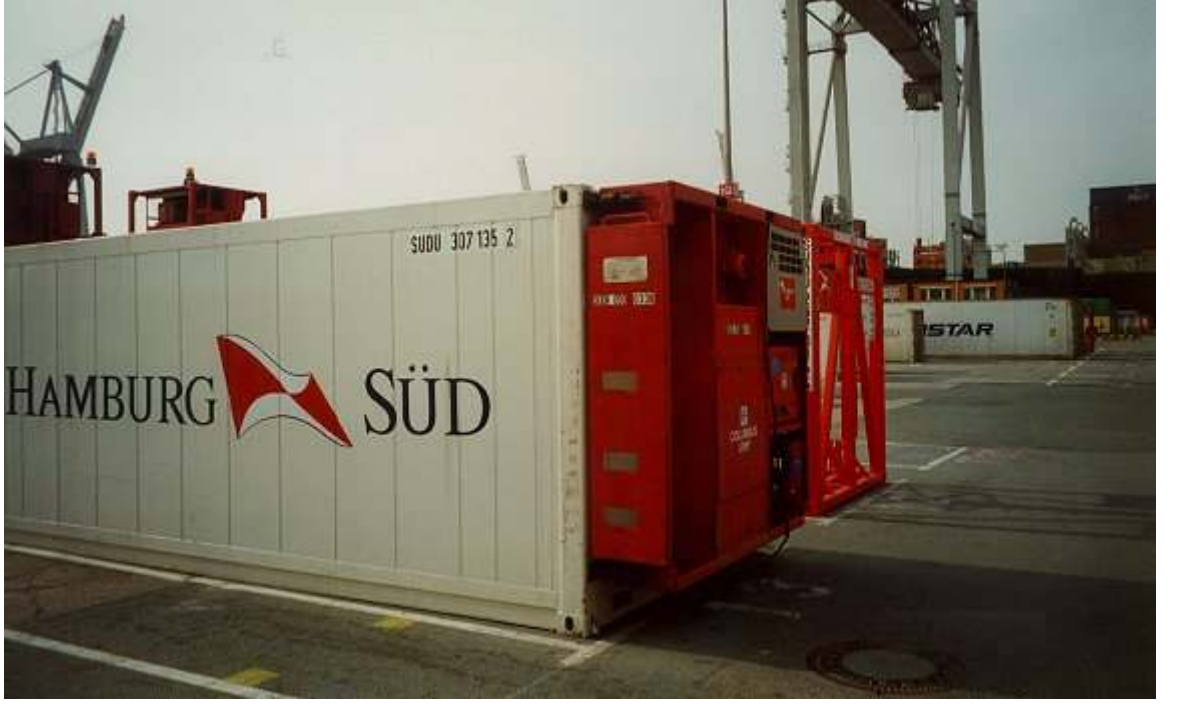
Resim-12/D Haricen Takılan Ünite İle Soğutmalı-Isıtmalı Konteyner
